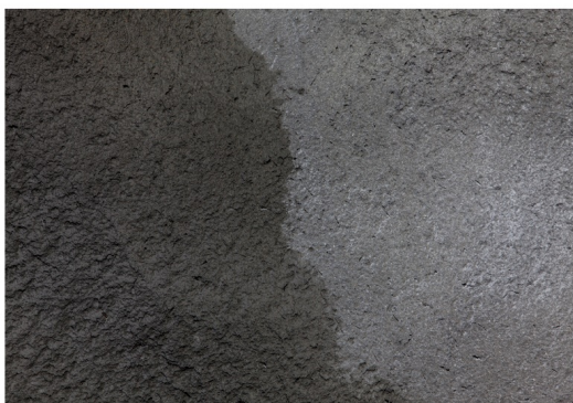
Figur 8 Fotograferad sprutbetongyta för mätningar av deformationer. Den vänstra halvan av sprutbetongen är blöt och i den högra figuren syns en ställinjal som användes som referens för skala.
