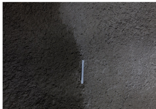
Figur 8 Fotograferad sprutbetongyta för mätningar av deformationer. Den vänstra halvan av sprutbetongen är blöt och i den högra figuren syns en ställinjal som användes som referens för skala.
